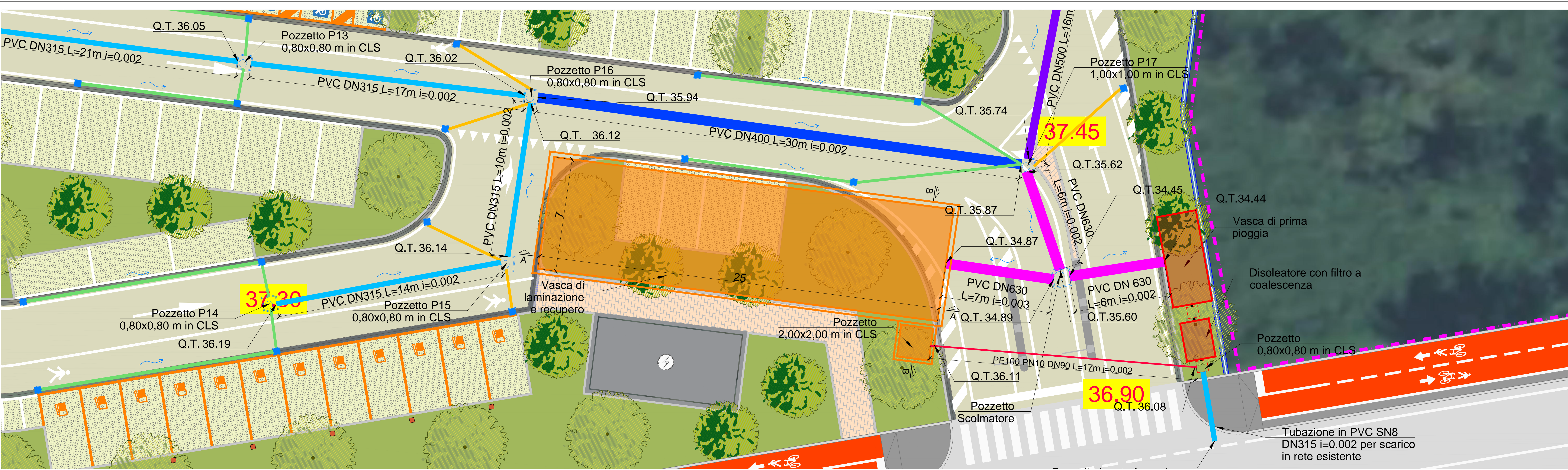
SCHEMA DI IMPIANTO DI PRIMA PIOGGIA IN DISCONTINUO Scala 1:50
